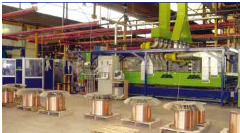
Sistema de alimentación de materia prima en primer plano. Detrás, máquina de esmaltar de hilo fino de última generación
